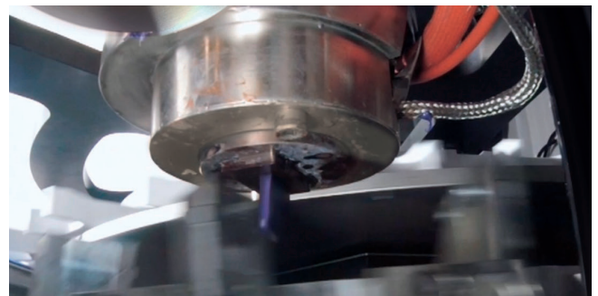
Bild 4. Das Abtrennen und Fördern der gewünschten Schmelzeportionen ist eine wichtige Etappe im Gesamtprozess © Sacmi
